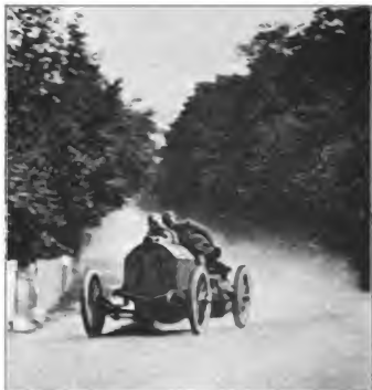
Storero (Fiat) nimmt die Kurve sehr scharf. Beachtenswert, wie sich der Mechaniker mit seinem ganzen Gewicht nach rechts hinüberlegt, um das Umstürzen oder zu starke Schleudern des Wagens durch die Zentrifugalkraft zu verhindern.
